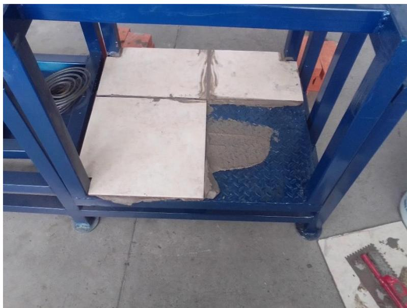
*Figura 38. Montaje de cama refractaria: aislante cerámico inferior.*
