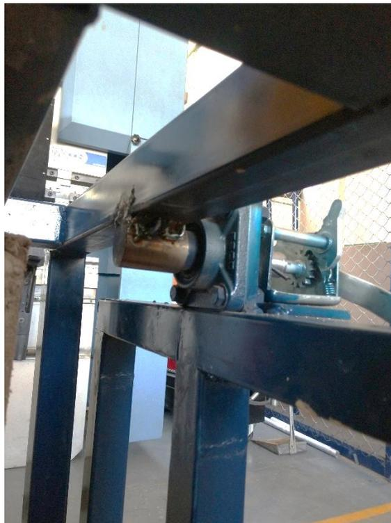
*Figura 50. Acercamiento eje de giro del porta-reactor.*
