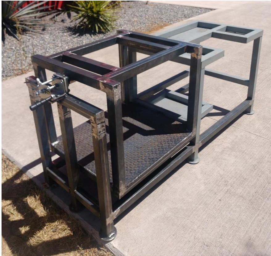
*Figura 37. Porta-reactor y porta-condensador integrados (antes del acabado final).*
