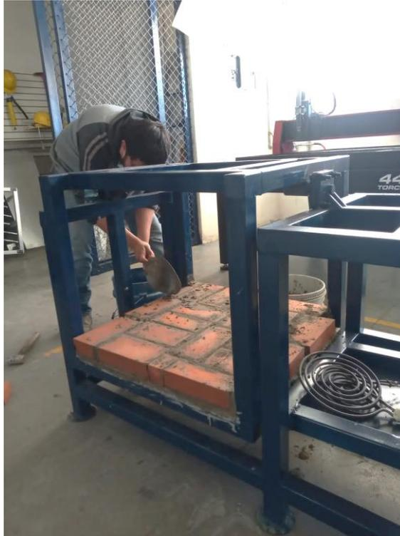
*Figura 39. Montaje de cama refractaria: ladrillo refractario.*
