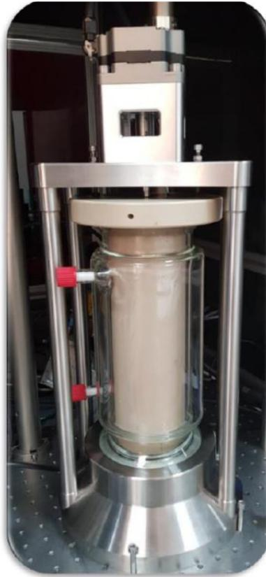
*Figura 8. Reactor con efecto vortex integrado para reacciones fotoquímicas desarrollado por Lee et al.<sup>31</sup>*
