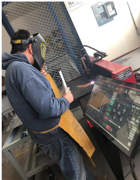
*Figura 34. Operación de cortadora de plasma para construcción de tapa.*
