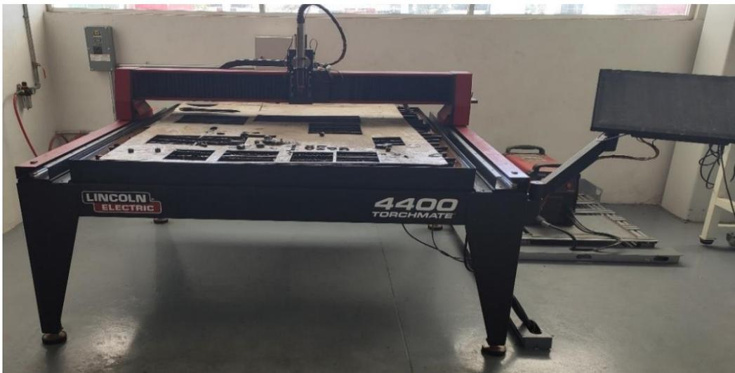
*Figura 20. Máquina de plasma LINCOLN ELECTRIC 4400 (fuente: Martínez-Casillas).<sup>33</sup>*
