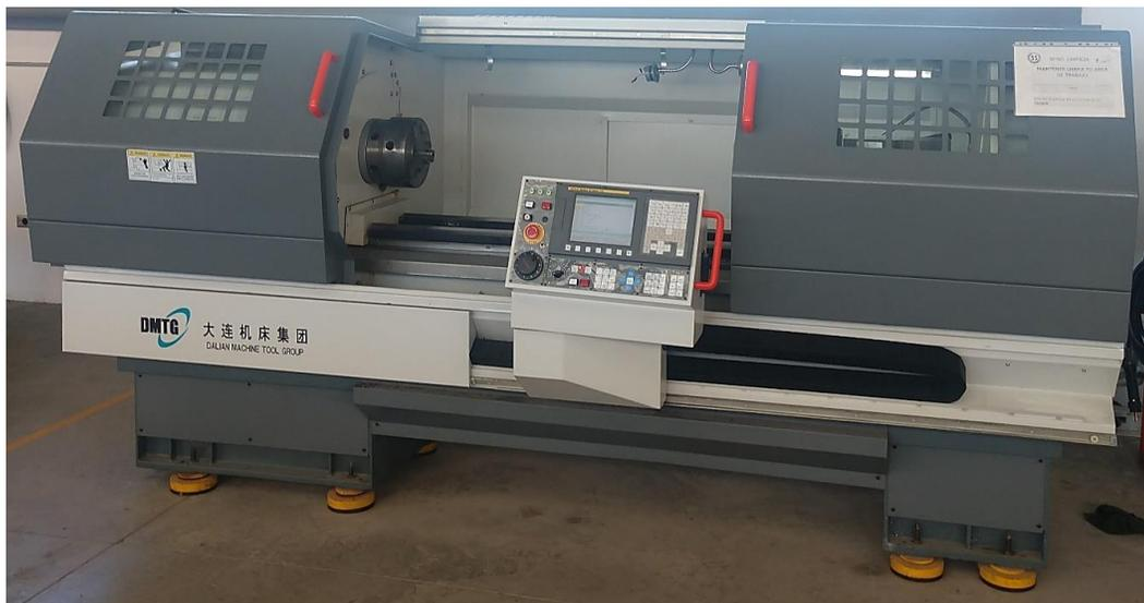
*Figura 21. Torno CNC DMTG CKE 6150Z. (fuente: Martínez-Casillas).<sup>33</sup>*
