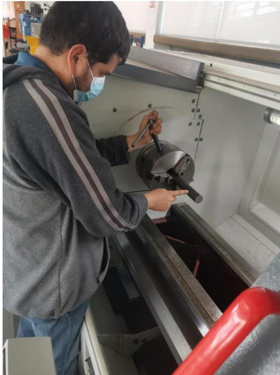
*Figura 35. Operación de torneado de ejes de giro del porta-reactor.*
