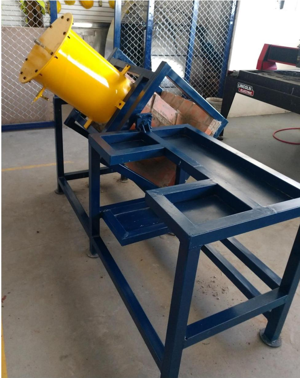
*Figura 47. Equipo pirolizado concluido: vista 1, inclinación 45°.*
