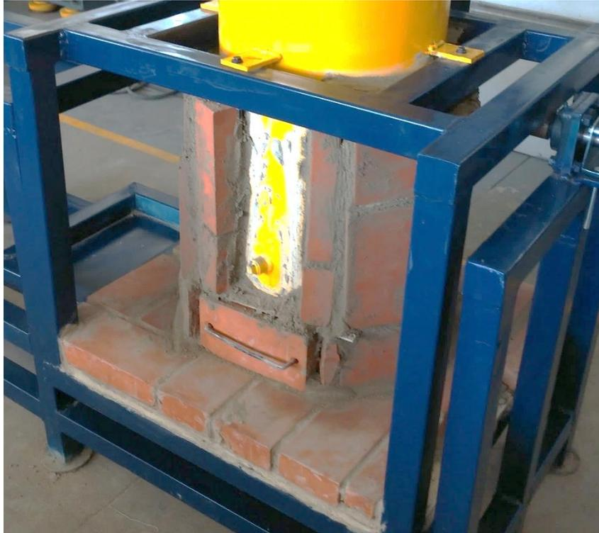
*Figura 49. Acercamiento zona de hospedaje de resistencia eléctrica.*
