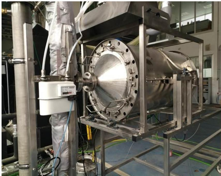
*Figura 7. Reactor de pirólisis de tambor rotativo.*
