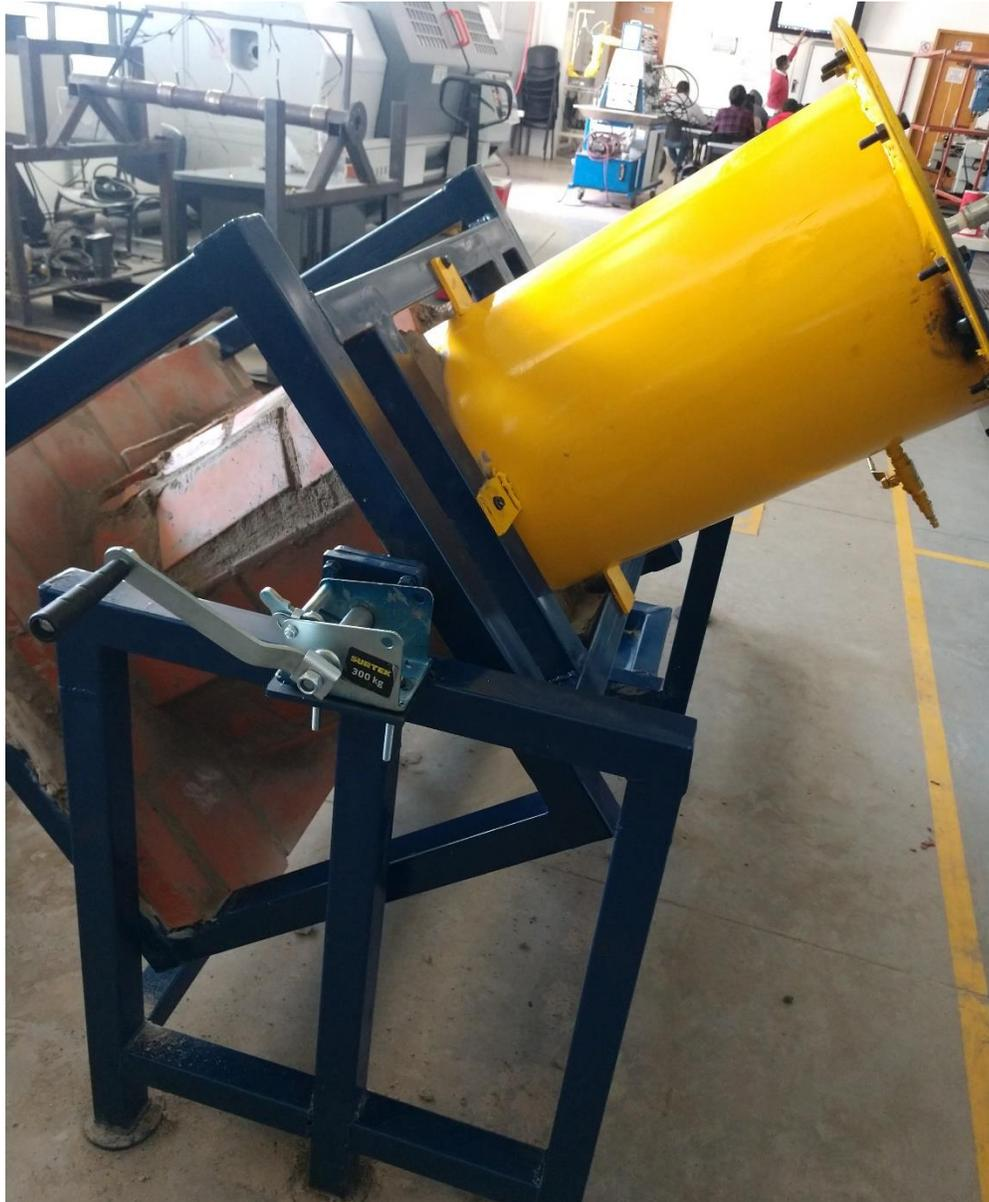
*Figura 48. Equipo pirolizado concluido: vista 2, inclinación 45°.*
